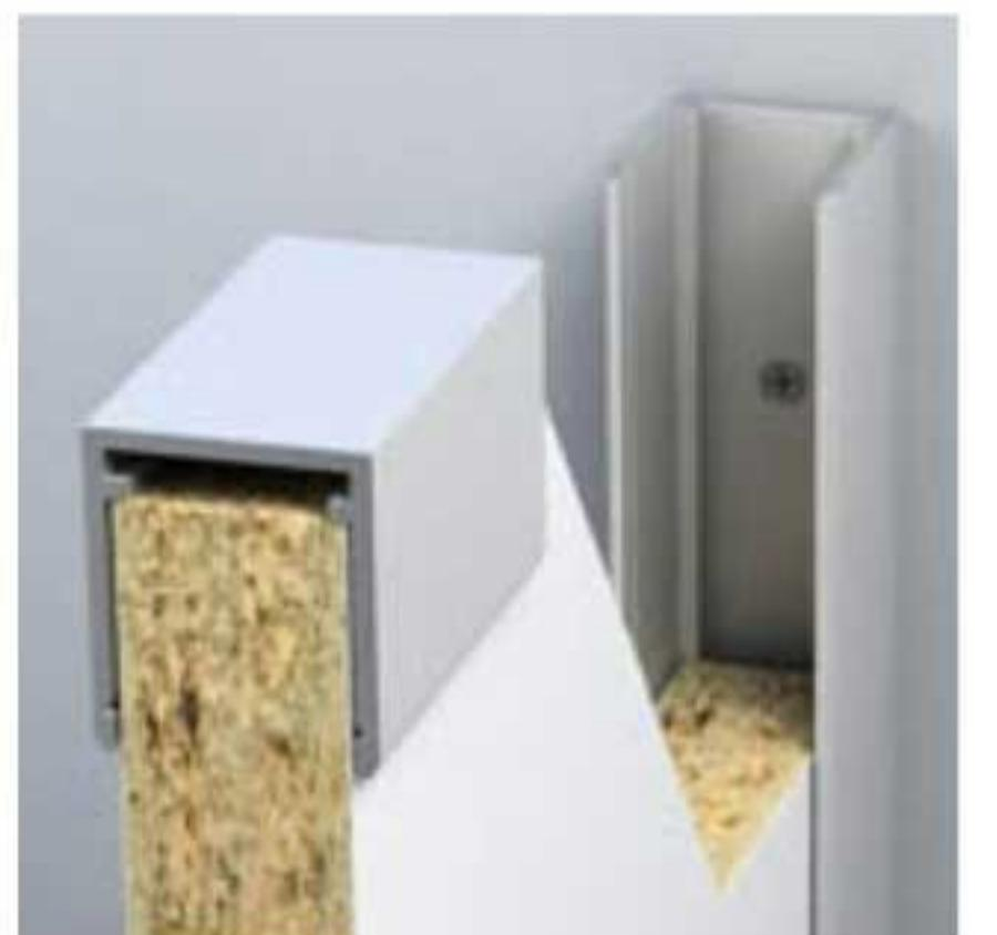
Применение разнообразных заполнителей (ДСП или ячеистый поликарбонат) позволяет варьировать как дизайн, так и цену сантехнических перегородок. Также возможны различные варианты оформления торцов: от экономичного без заделки или с заделкой пластиковой кромкой, до декоративного варианта заделки с помощью окантовочного профиля из алюминия.
