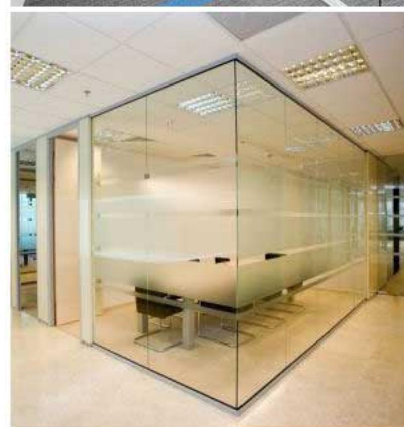
Монтаж стеклянных секций осуществляется безрамным методом встык при соблюдении технического зазора 0-2 мм.
